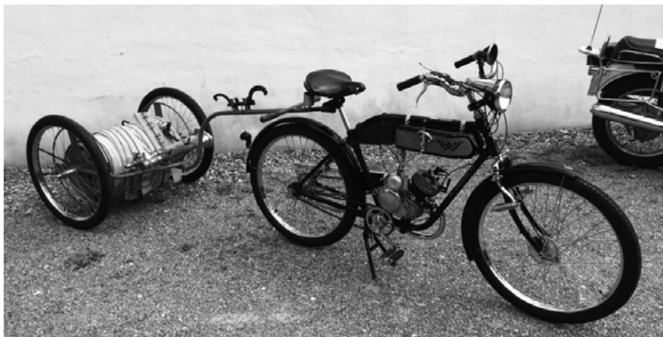
Es handelt sich dabei um den "Schlauchwagen" einer Werkfeuerwehr auf "Fahrgestell" Wanderer, Fahrrad mit Hilfsmotor. Der Motor hatte 98 ccm, die "Sondersignalanlage" besteht aus einem der ersten Blaulichter die es gab und einer einfachen Tröte. Alles aus den 30er Jahren, wie unser Zweiradspezialist Roland Planert dazu wusste.
