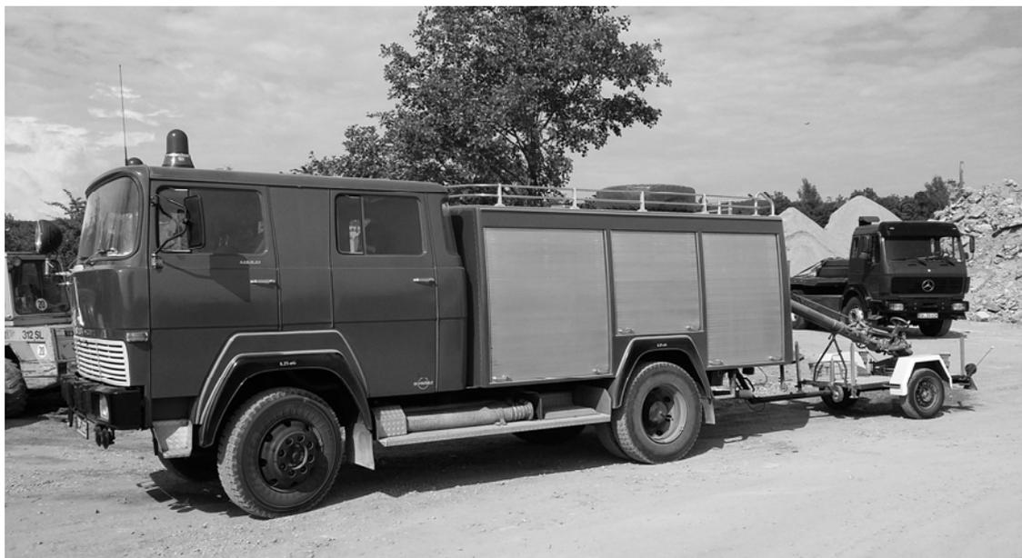
Ein Höhepunkt unser „Wasserspiele“ war sicherlich die von Andreas aus dem Hessischen mitgebrachte TST 40/7 von Magirus. Eine Tragkraftspritze mit Turbinenantrieb. Ein irres Gerät, bringt 4000 L/min, macht einen ordentlichen Krach und braucht gehörig Sprit. Auch der Kurt, der seinen Wasserwerfer mitbrachte, war überrascht und zugleich beeindruckt von der
