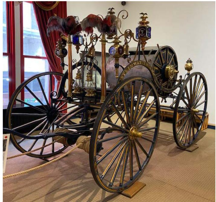
Die beiden Bilder oben zeigen eine Dampfdruck-spritze, motorisiert und pferdegezogen. Die überdimensionale "Wäschetrommel" auf dem Wagen diente zum Aufrollen großer Schläuche.
