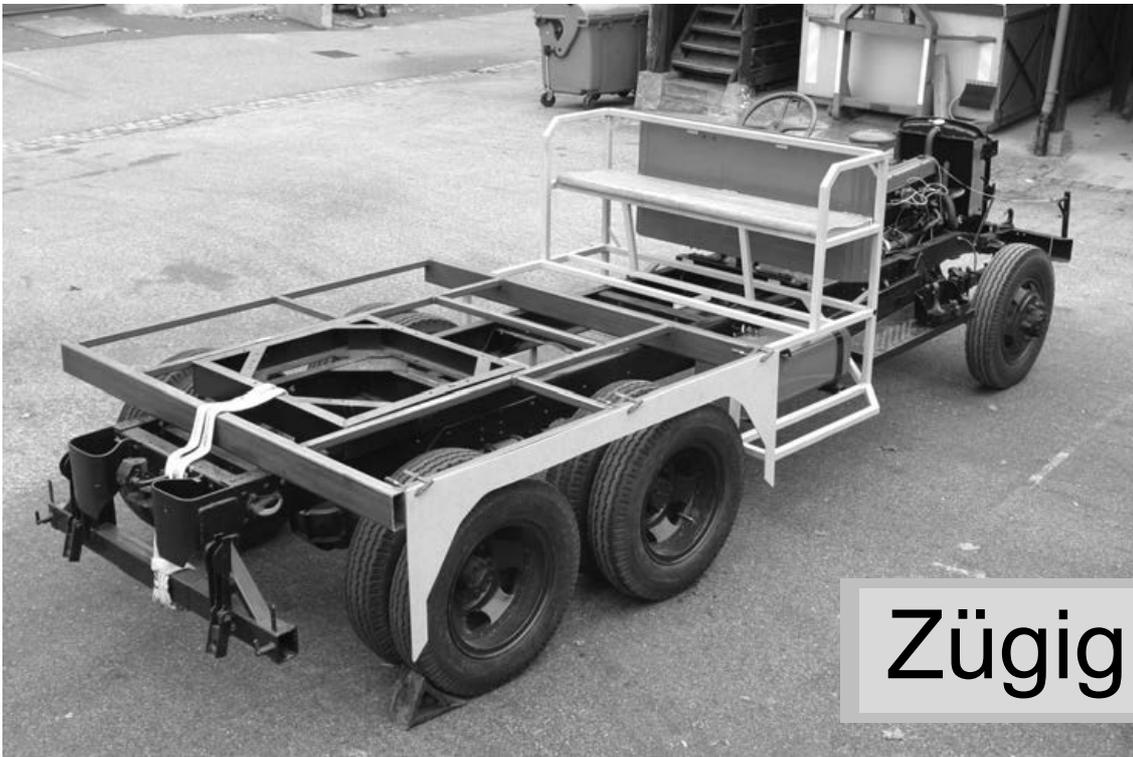
Ein Blick von oben zeigt den guten Fortschritt der Arbeiten. Der Rahmen für's Podium, Mannschafts- und Geräteraumrahmen sind fertig, der Motor ist montiert. Eine Holzschablone deutet schon die Verkleidung des Radkastens an.
