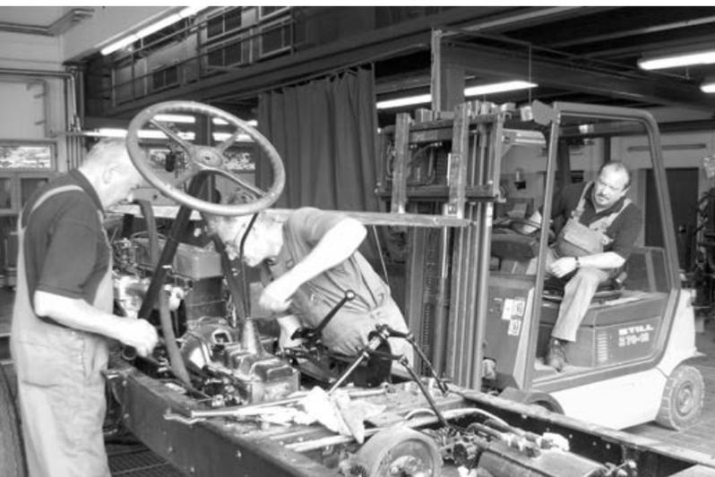
Die Profis heben den überholten Motor in das Fahrgestell
