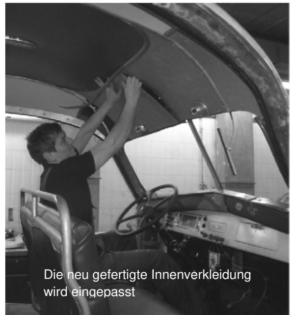
Die neu gefertigte Innenverkleidung wird eingepasst
