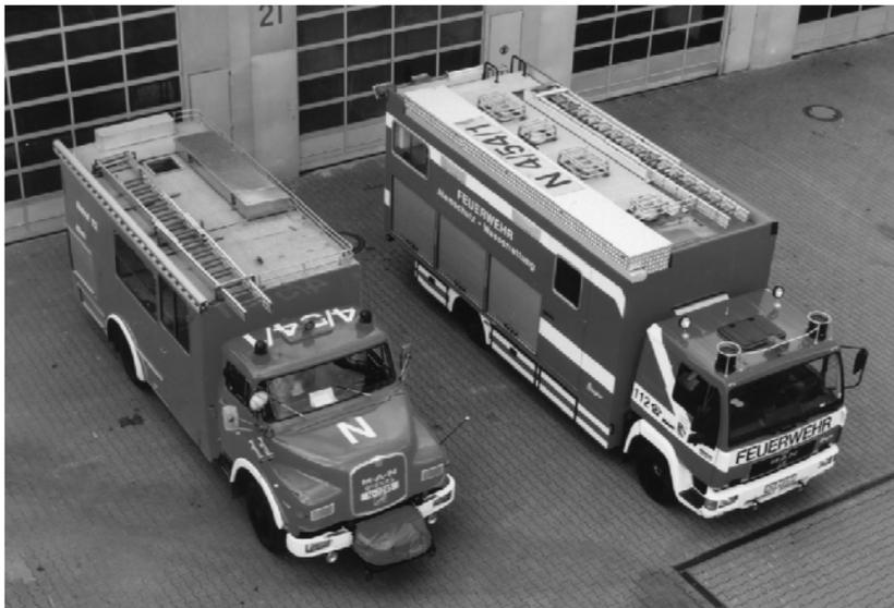
Fahrgestell: MAN 10.224 LLC/43 Silent, 6-Zyl. Diesel mit 162 kW, Straßenfahrgestell, Aufbauhersteller: Firma Albert Ziegler, Giengen und Hensel Fahrzeugbau GmbH, Waldbrunn. Baujahr 1998, Indienststellung Juni 1999, Zulässiges Gesamtgewicht: 10000 kg, Farbe: RAL 3000/9010, Kennzeichen: N - 2947
