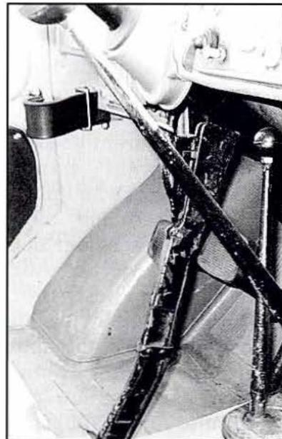
Bild innen: Hakenleiter, vierteilige Steckleiter und dreiteilige Schiebleiter (von unten) gehörten zur Beladung des LF 16. Die Hakenleiter ist bei den moderneren Löschfahrzeugen weggefallen.
