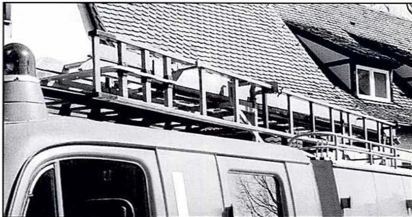
Die drei Leitern (Haken-, Schieb- und Steckleiter) wurden für den Fototermin aus dem Feuerwehr-Fundus entliehen und gehörten ursprünglich zu einem anderen Fahrzeug.
