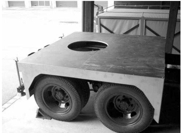
Fast wie poliert zeigen sich die Blechteile der Chassisverkleidung. Die Stützspindeln sind allesamt sandgestrahlt und sauber in elegantem Schwarz lackiert. Selbstverständlich sind Diese auch funktionsfähig.
