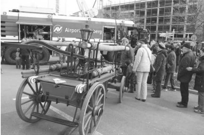
In diesem Jahr wurde das derzeit modernste Flughafenlöschfahrzeug (Bauj. 2009) mit Löscharm ausgestellt. Zum Vergleich, wie sich die Löschtechnik entwickelt hat, stellte das Feuerwehrmuseum Nürnberg eine Handdruckspritze (Feuerwehr Nürnberg Baujahr 1879) zur Verfügung.
