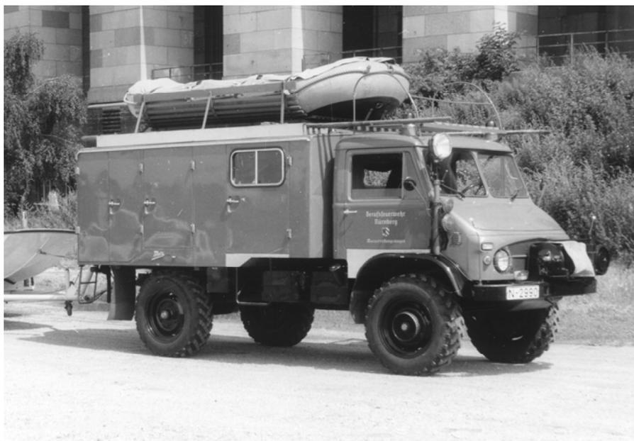
Fahrgestell: Daimler Benz Unimog S 404 80 PS
