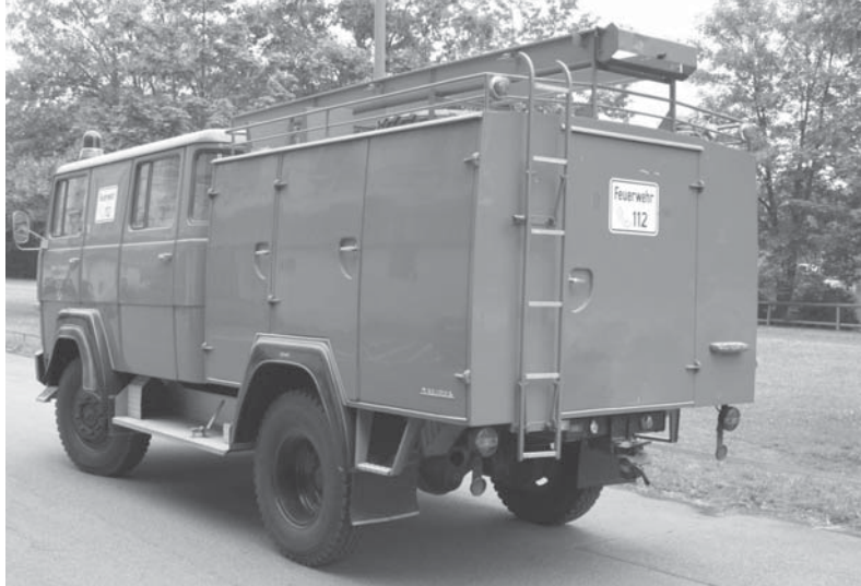
Der Aufstieg zur Dachbeladung erfolgte über eine abklappbare, sechssprossige Leiter am Heck des Fahrzeuges.
