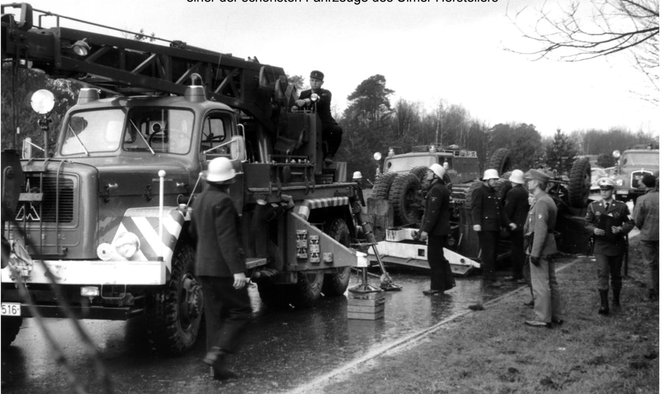
Fahrgestell: Magirus Deutz F Uranus A 250D25A 6x6, Dieselmotor F12L614 mit 250 PS
