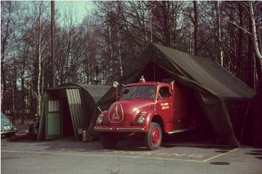
Die Feuerwache auf der Großen Straße bestand aus mehreren Zelten sowie Wellblech-Baracken. Ein Magirus Deutz Rundhauber bildet die Basis für ein Löschfahrzeug nach amerikanischem Vorbild: Pumpenbedienstand und Druckabgänge befanden sich seitlich hinter der Fahrzeugkabine; auf einem offenen Schlauchbett wurden die Druckschläuche transportiert. 2 Firemen der Besatzung mussten auf dem hinteren Trittbrett mitfahren, da die Kabine nur für 2 Mann ausgelegt war.
